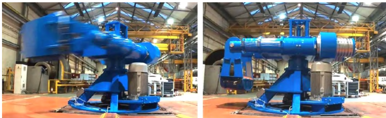
离心机出厂前整机开机测试
