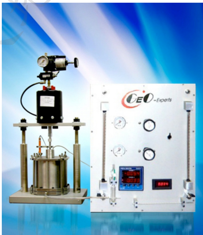
新型应力相关土水特征曲线量测系统
